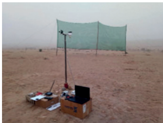
Figura N° 4. Estación meteorológica propia y automatizada para la microlocalización
